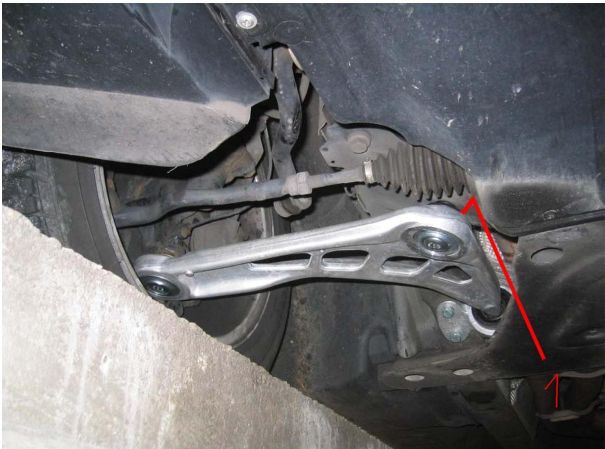
Beim aushebeln des mittleren Lager muss nicht unbedingt eine Brechstange vorhanden sein, jedoch geht es um einiges leichter als mit einer geraden Eisenstange oder Rohr. Zu beachten ist das man die Spurstange nicht berührt oder irgendwie belastet.
