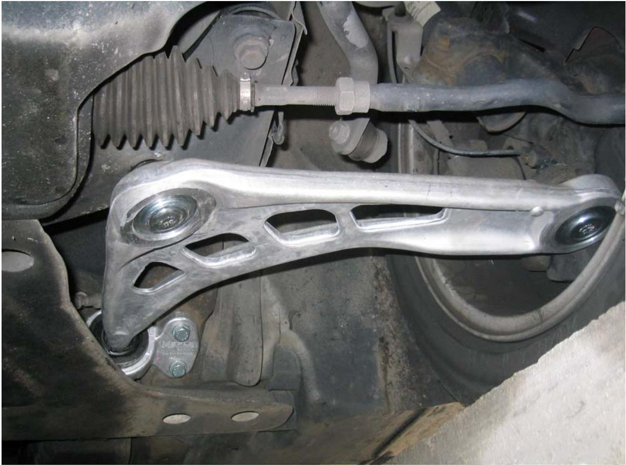
Eine Achsvermessung ist in der Regel nicht erforderlich, da keine der spurveränderlichen Komponenten verändert wurde. (Laut einem BMW –Mechaniker führt selbst BMW, nur bei E+ Reparaturen die Achsvermessung durch)
