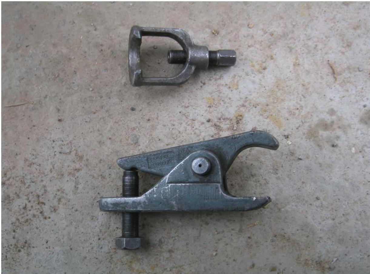
Die untere Variante ist zu empfehlen, da diese deutlich mehr Kraft auf die Lager ausübt.
